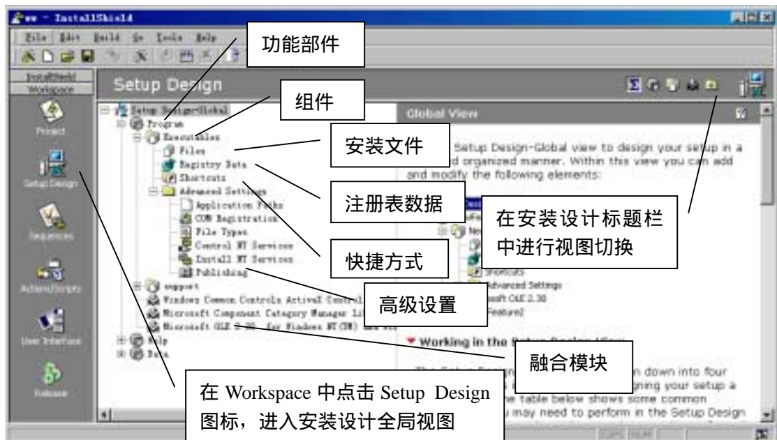
图 1-3 ISWI 设计中的“安装文件—组件—功能部件”结构
